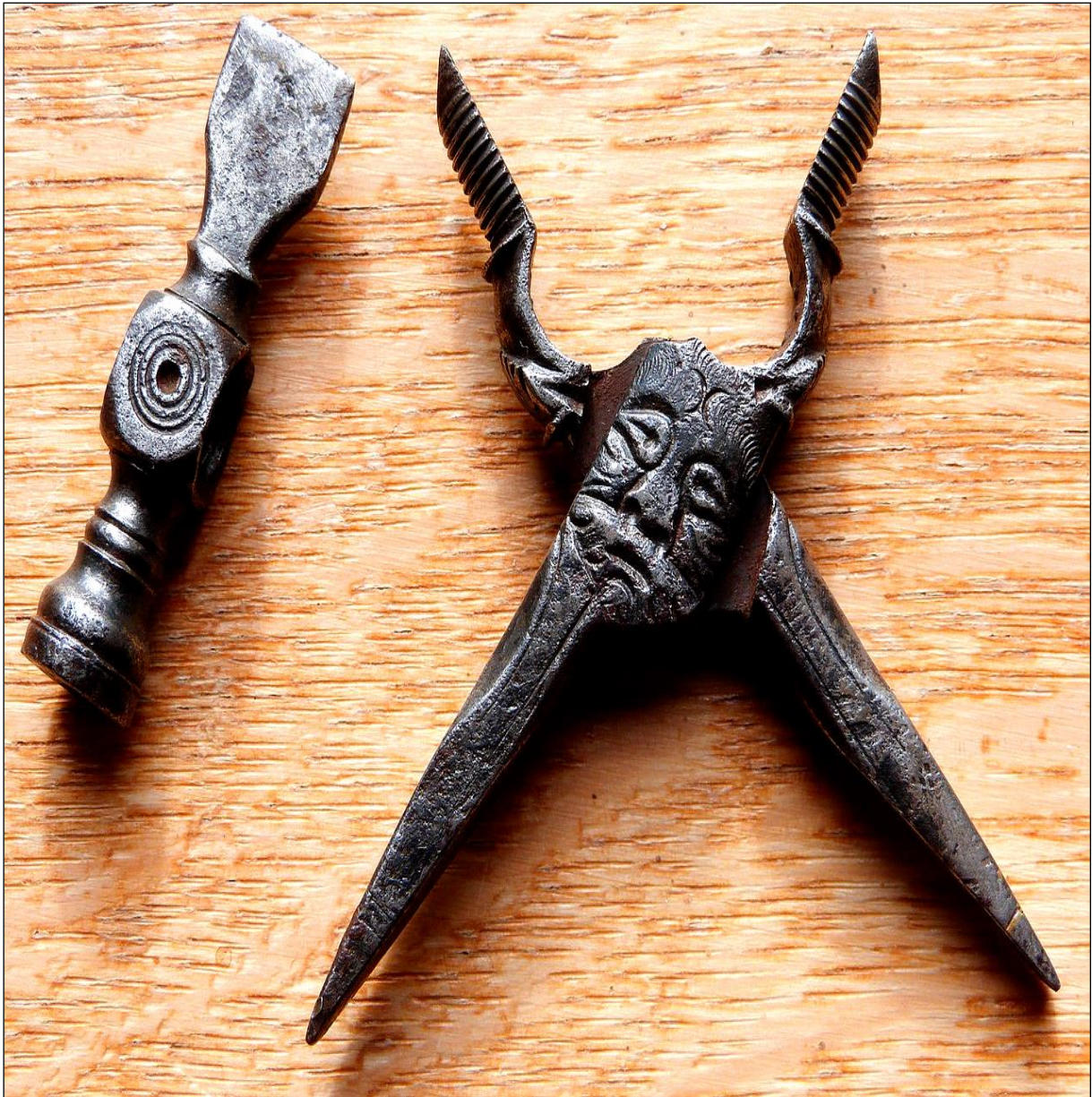
Marteau d'arquebusier ou armurier faisant outil combiné, ciseau à bois, pince et tournevis, XVII e sûrement Nuremberg, 9 cm.
