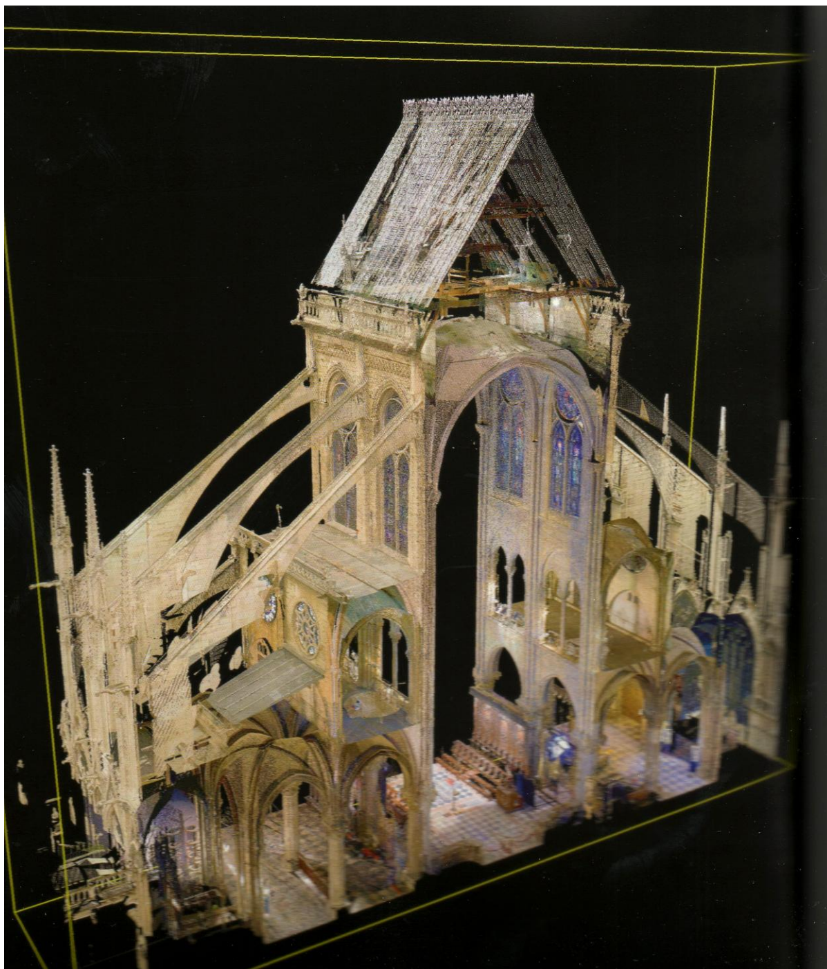
Nuage de points acquis par scanner laser Leica C10 en janvier 2010, vue axonométrique sur une des travées droites du chœur. Photo et légende voir note n°9.
