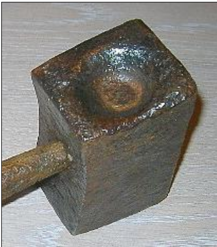
Massette de tailleur de pierre (casse-cailloux 5 ). La tête du burin a creusé le marteau 6 .
