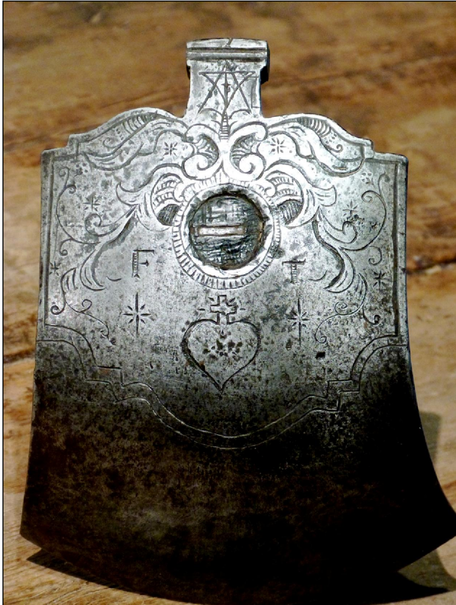
Dessous d'un fer d'une herminette de tonnelier, dite asse de rognage, de type mâconnais, XVIIe.
