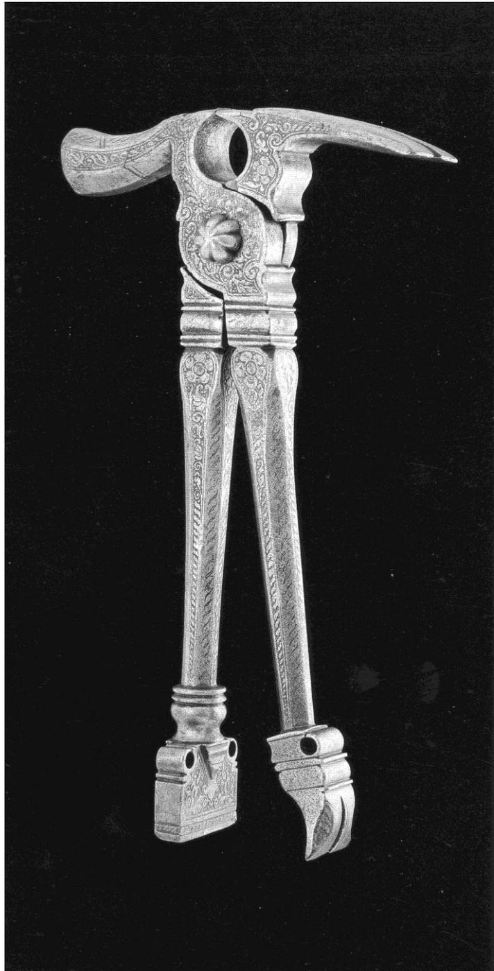
de vigne) allie l'élégance des formes et la fonctionnalité. Il peut servir de tenaille, de marteau ou encore de tire-clous. Probablement utilisé dans la fabrication d'armes, il présente des analogies étonnantes avec les tenailles réalisées pour le compte d'Auguste de Saxe et actuellement exposées dans le Rüstkammer de Dresde.
