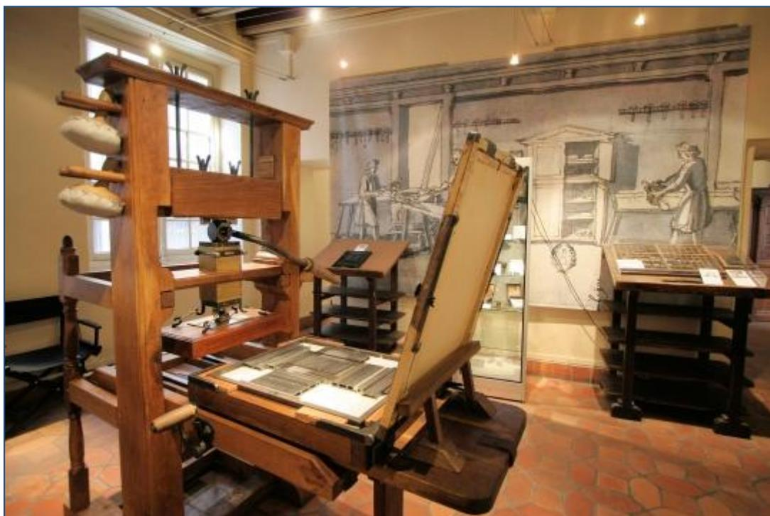
L'outil, appelé aussi presse à bras, composé de bois de sections importantes, était entièrement démontable pour le transport et le passage des portes.
